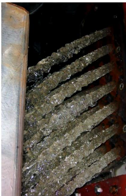
Jets d'eau parallèles - à partir du stock de buses aux plaques cibles d'électrodes
